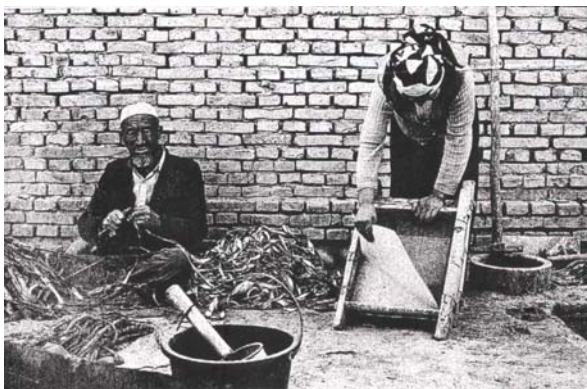
圖二：新疆和闐用「澆」法做的桑皮紙，曬乾後，工人正將紙從網架上撕下來，一個網架一次只能澆一張紙，故較原始。（蕭輝華攝影）
